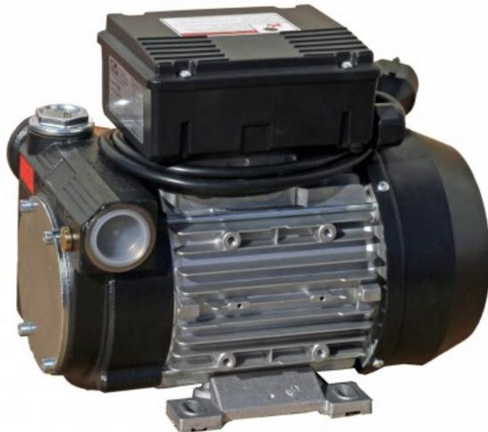
Trocken-selbstansaugende Dieselpumpe 230V max. 150 l/min. Bypassventil, Edelstahl Saugsieb, Anschlüsse 1" IG Netzschalter, 2m Kabel mit Schukostecker.
